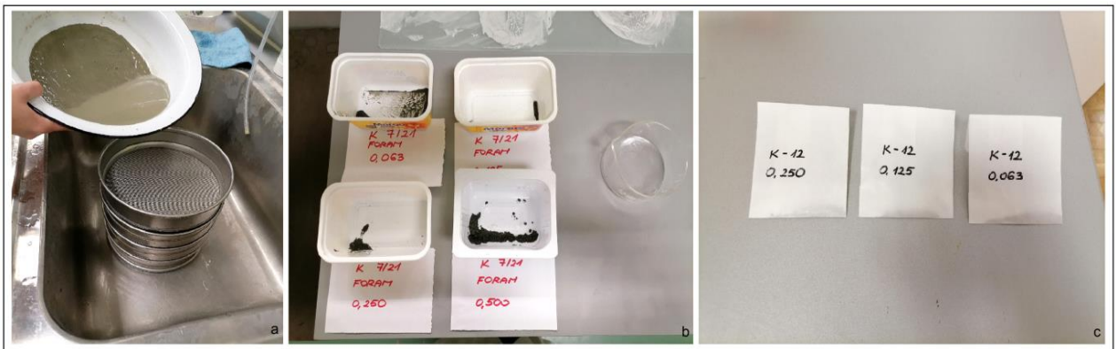
Slika 11: a) Metoda mokrog sisanja; b) Odvojene frakcije spremne za sušenje; c) Osušene i zapakirane frakcije u papirnatim vrećicama
