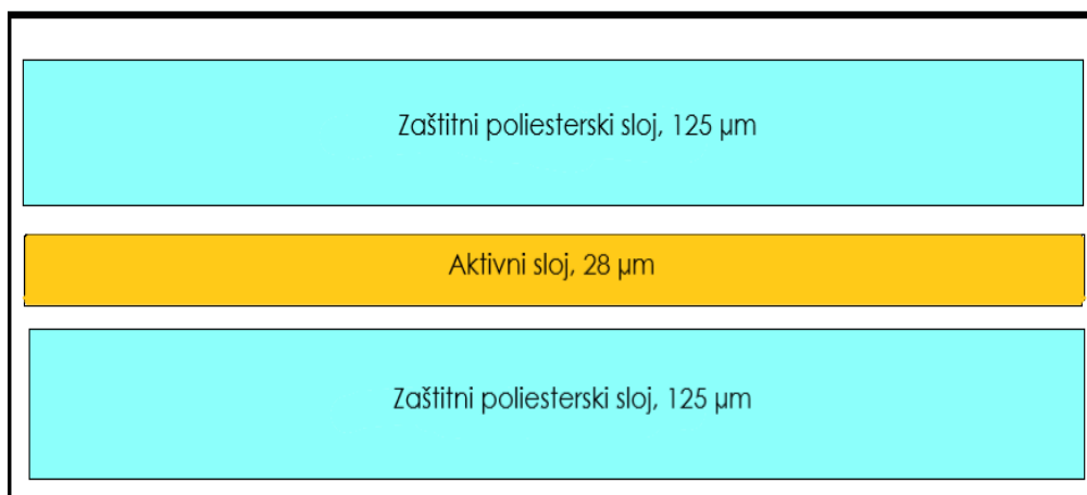
Slika 3.2: Shematski prikaz poprečnog presjeka GafChromic EBT3 filma.
