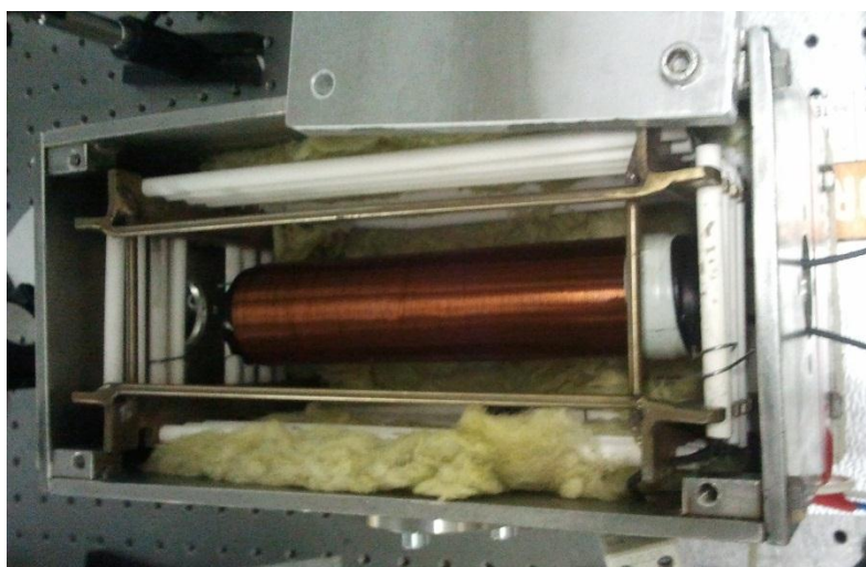
Slika 32: Unutrašnjost peći. Uočavamo zavojnicu, unutar nje se nalazi naša kiveta punjena kalijem. Oko peći se vidi kamena vuna za bolju stabilizaciju temperature prilikom mjerenja.
