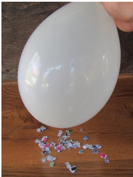
Slika 3.17. Nabijeni balon privlači neutralne papiriće.
