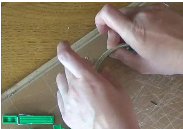
Slika 2.13. Lijepljenje zrcala dvokomponentnim ljepilom.
