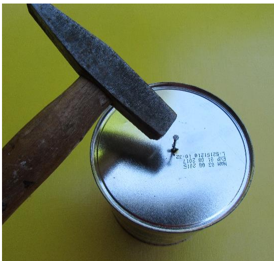
Slika 5.13. Bušenje rupice zabijanjem čavla.
