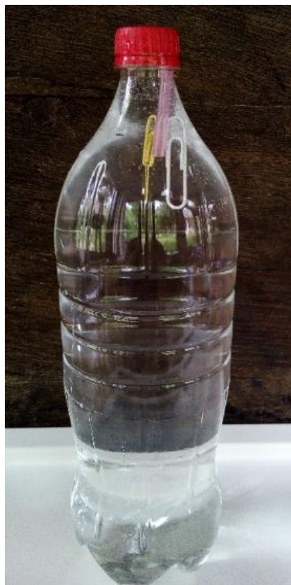
Slika 4.11. Ronilac pluta na vrhu boce.
