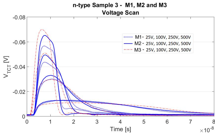
Slika 8.7: Signali dobiveni TCT analizom crvenim laserom uzorka 3 n-tipa. Prikazani su signali izmjereni na 25, 100, 250 i 500 V u sva tri seta mjerenja.
