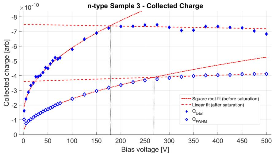
Slika 8.6: Graf prikazuje ovisnost prikupljenog naboja o naponu na detektoru.  $Q_{tot}$  predstavlja naboj sadržan u cijelom pulsu, a  $Q_{FWHM}$  je naboj sadržan unutar FWHM pulsa. Prije saturacije naboj se mijenja kao korjen nametnutog napona. Pošto FWHM integracija signala zanemaruje dio prikupljenog naboja, saturacija je sporija.
