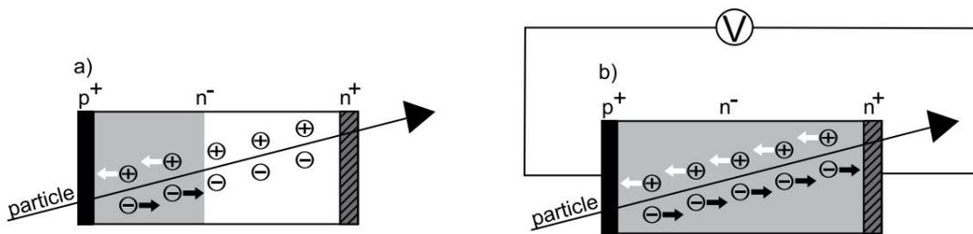
Slika 8.2: a) Elektroni i šupljine generirani u području osiromašenja brzo su prikupljeni na elektrodama. U ostatku  $n^-$  volumena nema električnog polja, generirani naboji nasumično se gibaju kroz kristal i ne doprinose indukciji signala; b) Reverzna polarizacija detektora omogućava širenje osjetljive zone na cijeli dostupni volumen [5].
