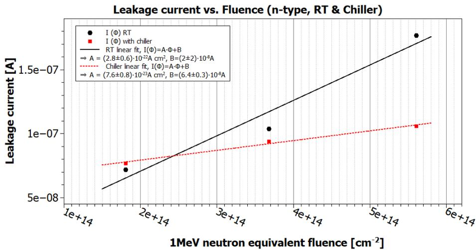
Slika 8.9: Porast struje kroz detektor u reverznoj polarizaciji u ovisnosti o apsorbiranoj dozi zračenja izraženoj u mjernoj jedinici  $1 \text{ MeV } n_{eq}/\text{cm}^2$ . Prikazani su podaci iz M2 i M3 mjerenja detektora n-tipa.
