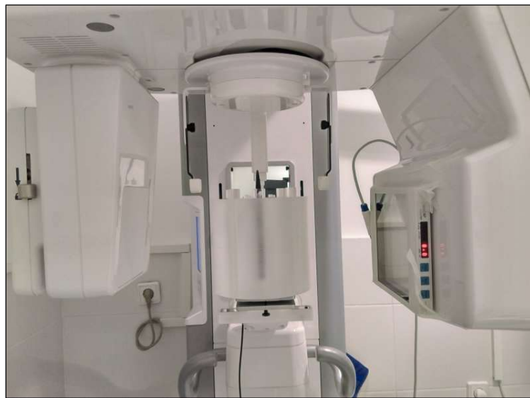
Slika 12. Mjerenje CTDI-a i DAP-a. DAP-metar postavljen je na izlaz rendgenske cijevi.
