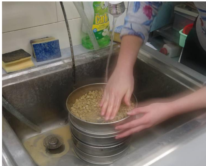
Slika 12. Prosijavanje uzoraka kroz sita pod mlazom vode u laboratoriju GPZ-a.
