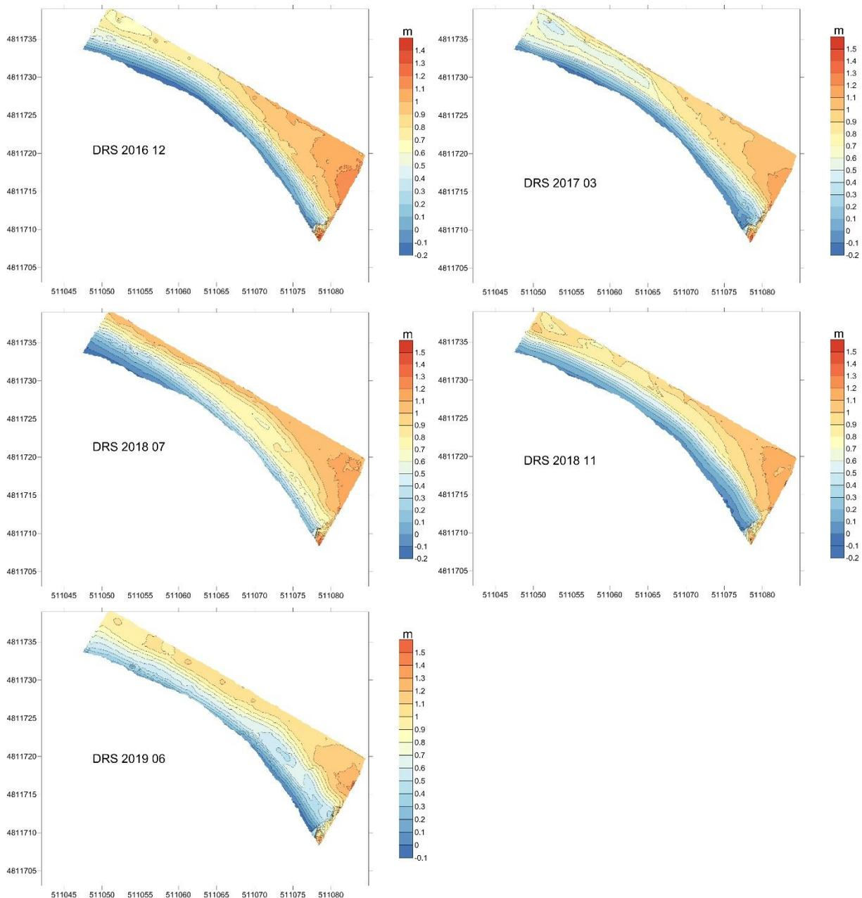
Slika 21. Digitalni elevacijski modeli južnog dijela plaže.
