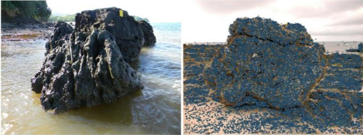
Slika 11. Utjecaj svjetlosnih uvjeta na automatsko prepoznavanje točaka na snimanom objektu. Vulkanska stijena na otoku Fiji (lijevo) i karbonatna stijena na Taiwanu (desno). Obje stijene imaju nepravilnu površinu no samo je karbonatna stijena snimljena pod idealnim svjetlosnim uvjetima, što je u programu kasnije omogućilo automatsko prepoznavanje značajnih točaka (Gienko i Terry, 2014).
