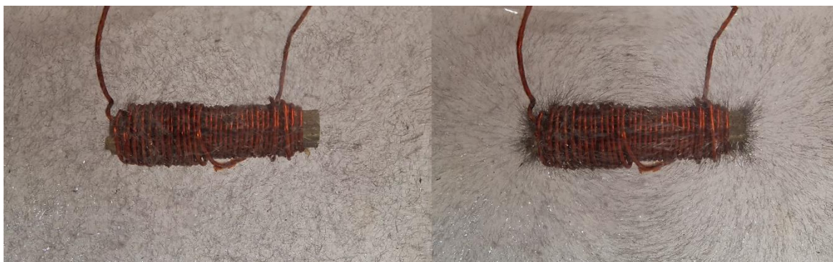
Slika 23 Prije puštanja struje kroz zavojnicu (lijevo), nakon puštanja struje kroz zavojnicu (desno)
