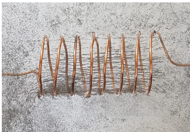
Slika 21 Silnice magnetskog polja dobivene pomoću željezne piljevine
