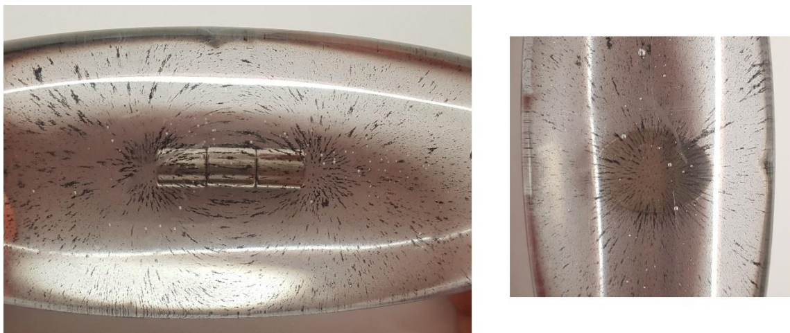
Slika 26 Silnice magneta oblika valjka (lijevo), silnice okruglog magneta (desno)
