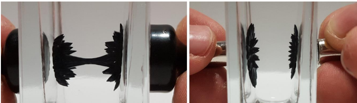
Slika 14 Privlačenje magneta (lijevo), odbijanje magneta (desno)
