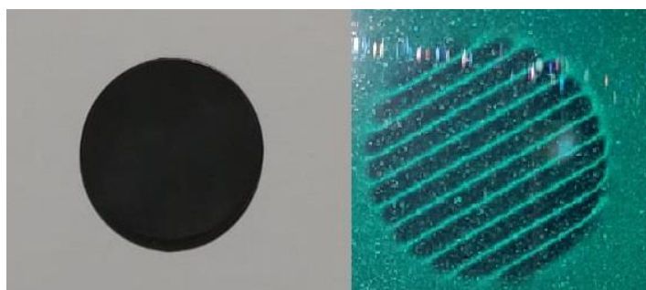
Slika 32 Magnet za hladnjak i slika nastala na zelenoj foliji zbog magnetskog polja magneta
