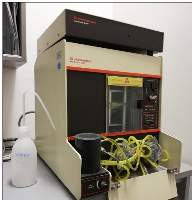
Slika 9 Sedigraf korišten pri granulometrijskoj analizi sedimenta
