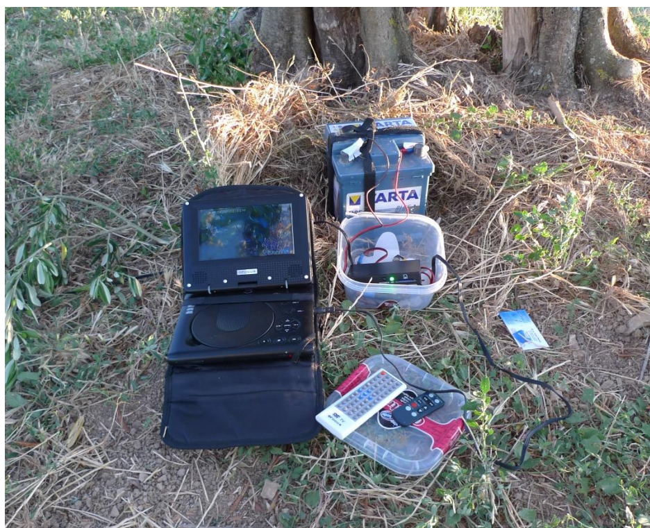
Slika 7. SD snimač u vodootpornoj kutiji spojen s akumulatorom i prijenosnim DVD reproduktorom.
