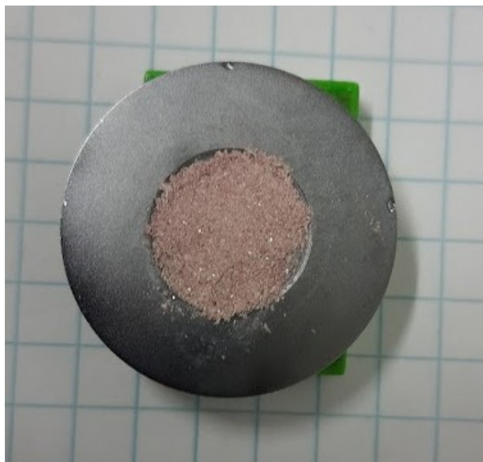
Slika 17. Uzorak NEW TTC-a pripremljen za mjerenje u difraktometru
