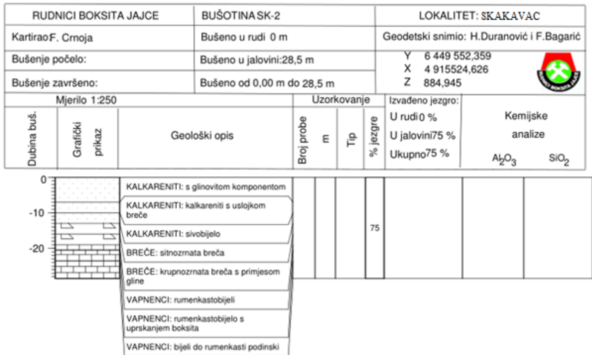
Slika 6-3. Prikaz litološkog stupa bušotine SK2
