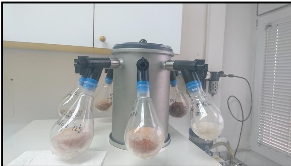
Slika 5-14. Liofilizator (foto: Lucija Mihaljević)
