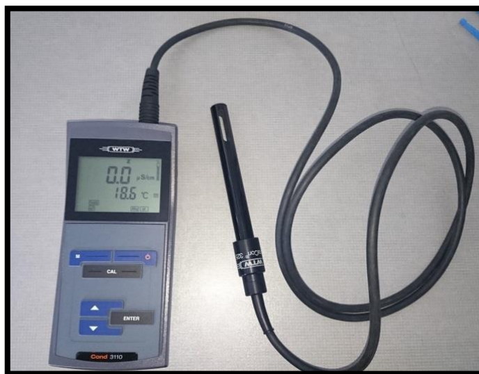
Slika 5-4. Konduktometar WTW cond 3110 CT (foto: Lucija Mihaljević)
