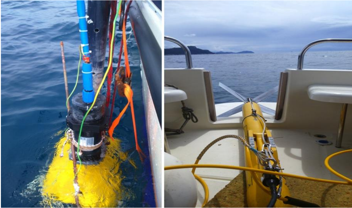
Slika 3.1. Geološki dubinomjer (engl. sub – bottom profiler ) lijevo, Panoramski dubinomjer (engl. side – scan sonar ) desno
