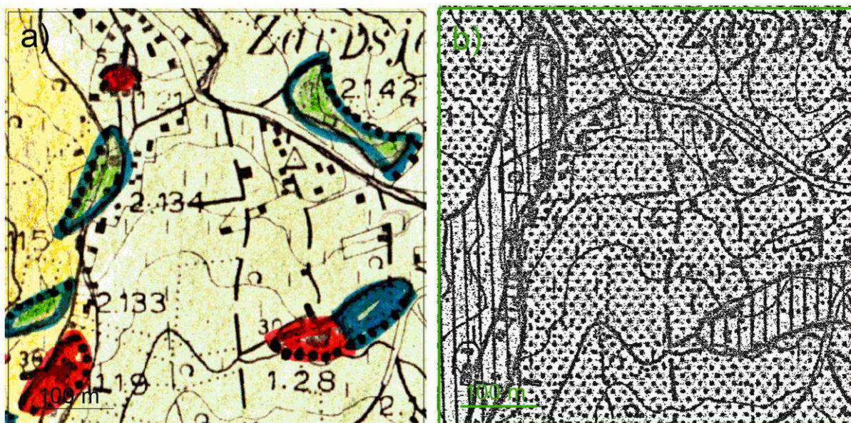
Slika 16 Isječci s karata iz studije Litološka obrada i kategorizacija terena prema stabilnosti tla obronaka Medvednice na području grada Zagreba iz 1979. godine ( Polak i dr., 1979 ) za područje Završja: a) isječak litološke karte izvornog mjerila 1:10.000 s prikazom granica klizišta od kojih su tri aktivna klizišta označena brojevima 1.19, 1.21, 1.28, a tri umirena klizišta označena su brojevima 2.133, 2.134, 2.142; i b) isječak karte podložnosti na klizanje s dvije vidljive zone nazvane: II. kategorija – umjerenost stabilne padine (označene točkastom šrafurom); i III. kategorija – umjerenost nestabilne padine (označene linijskom šrafurom)
