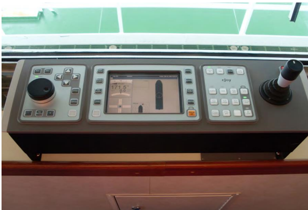
Slika 3-4. Komandna palica za ručno upravljanje potisnicima u izvanrednim stanjima (Pacific Drilling, 2009)
