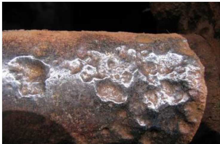
Slika 4-4. Vanjska korozija cjevovoda (corrosionpedia.com, 17.8.2020.)
