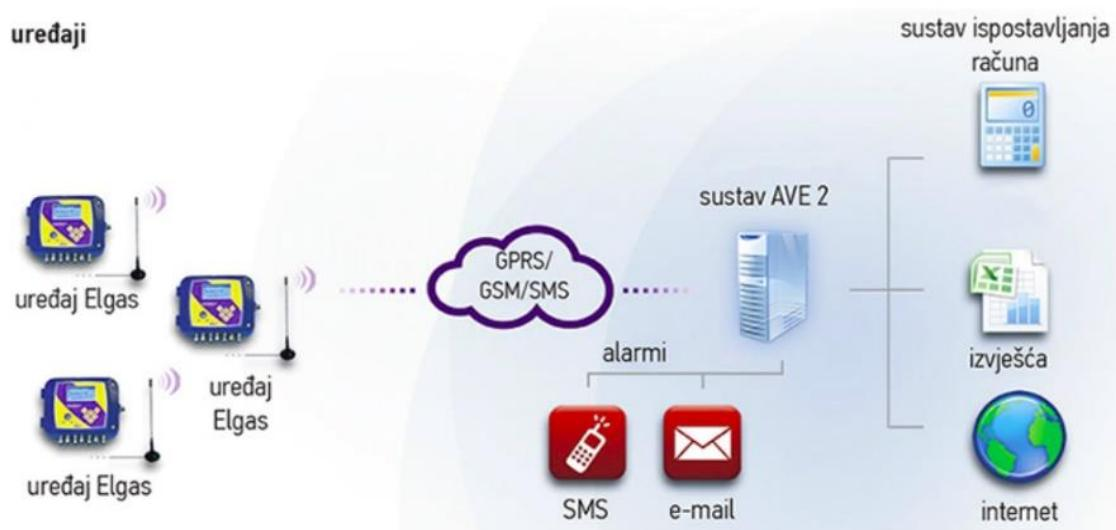
**Slika 2-6.** Način funkcioniranja GPRS/GSM tehnologija (Energetika.net 2018)
