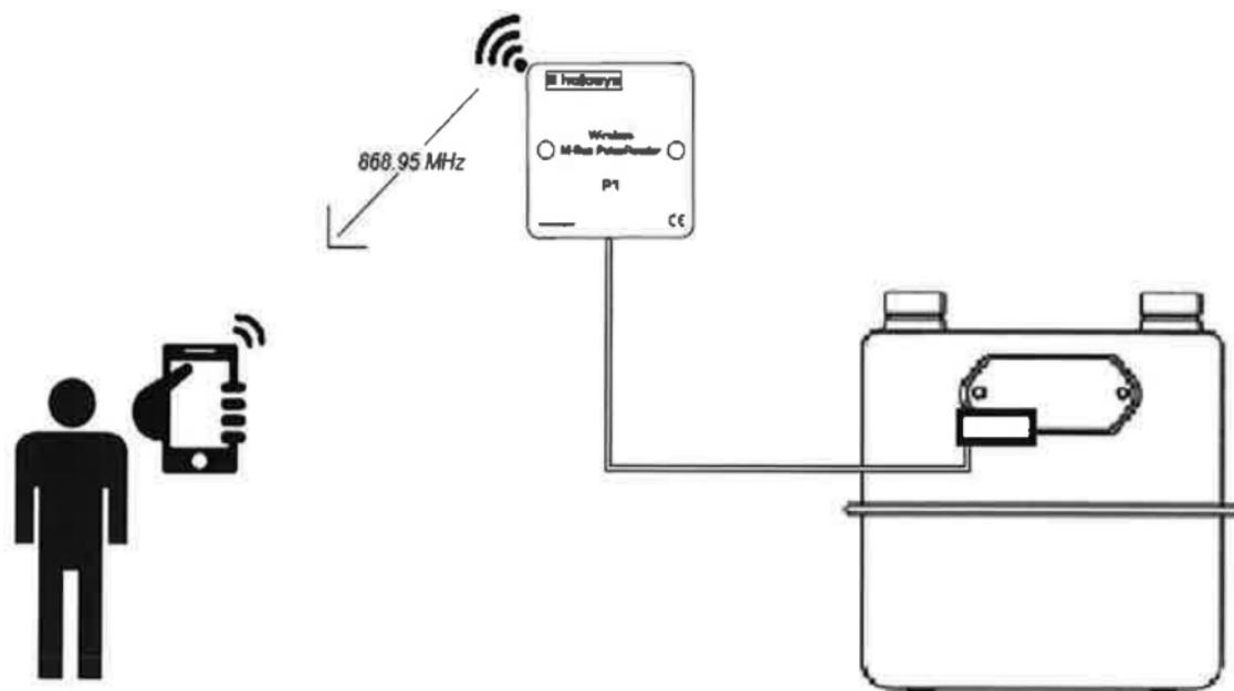
**Slika 2-5.** Oprema za očitanje potrošnje plina koristeći RF modul – frekvencija 868MHz (Gradska plinara Zagreb, 2018.)
