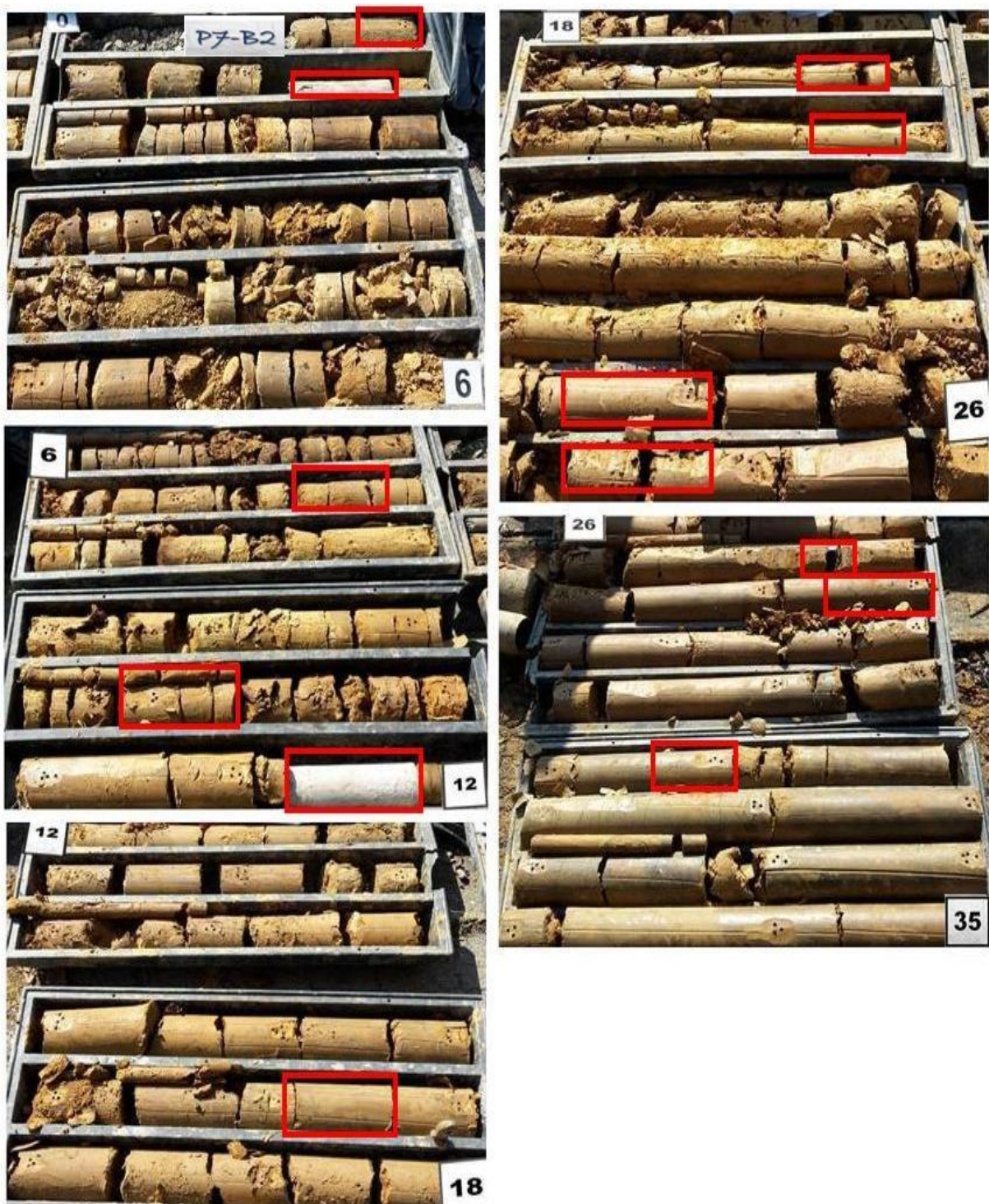
Slika 11 Jezgra bušotine P7- B2 (lokacija Krematorij), dubine 35 m s oznakama mjesta uzorkovanja za laboratorijska ispitivanja
