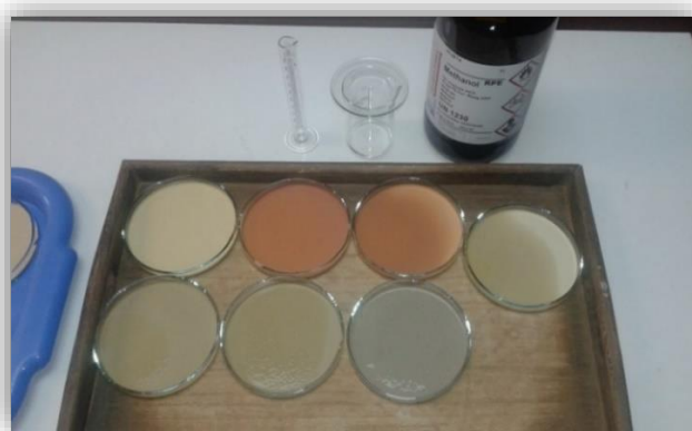
Slika 19 Sušenje uzoraka pomiješanih s ZnO i metanolom nakon usitnjavanja u McCronovom mlinu.
