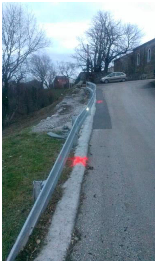
Slika 3.3 Oznake istraživačkih bušotina na cesti iznad klizišta (snimio Ž. Arbanas 14.2.2015.).
