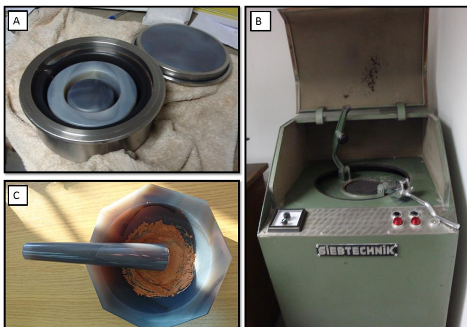
Slika 5-2. A) Čelična posuda s ahatnim „prstenom“ i „valjkom“, B) Kućište mlina, C) Ahatni tarionik s ahatnim tučkom (foto: Lucija Mihaljević)
