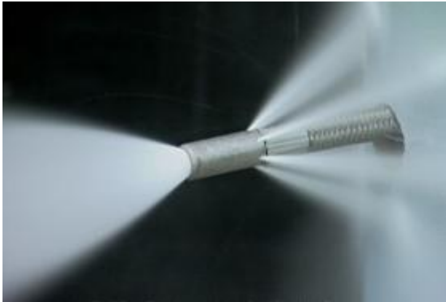
Slika 2-4. Buckmanova konusna mlaznica (Buckman Jet Drilling, 2003)
