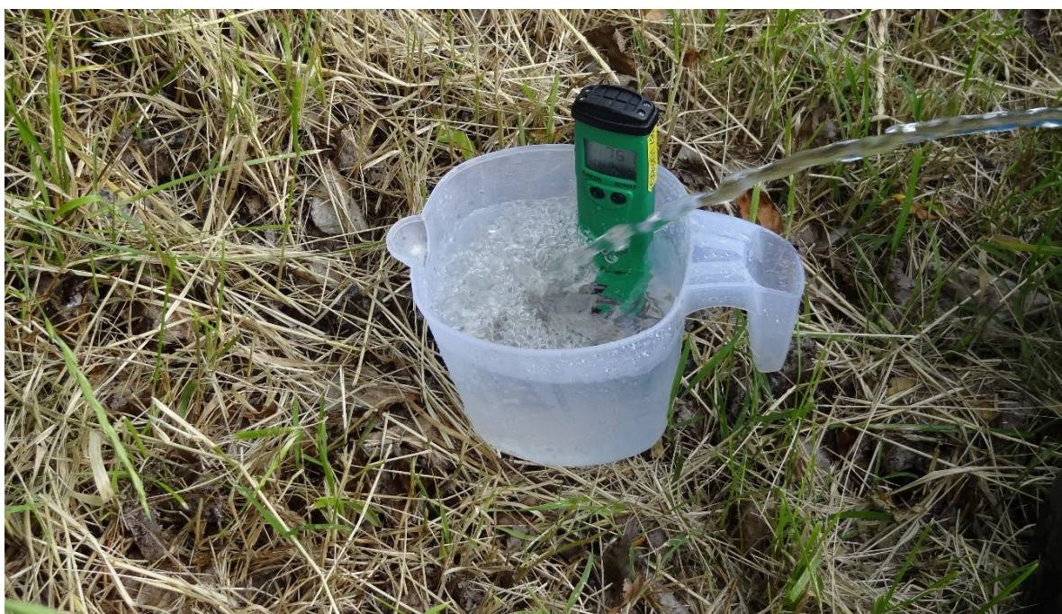
Slika 4.22. Mjerenje pH prije uzorkovanja na piezometru Mm-325
