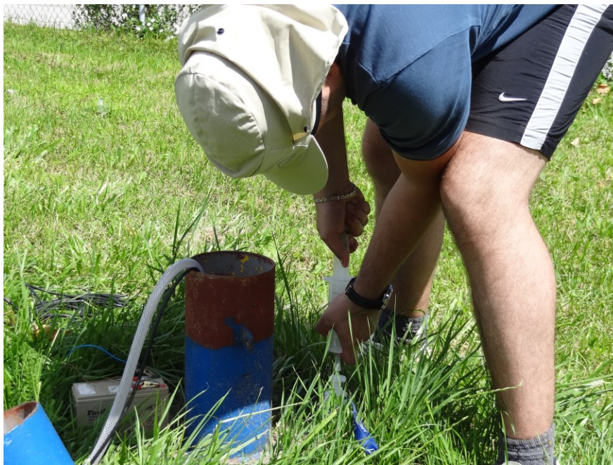
Slika 4.31. Filtriranje uzorka na piezometru Ž-8
