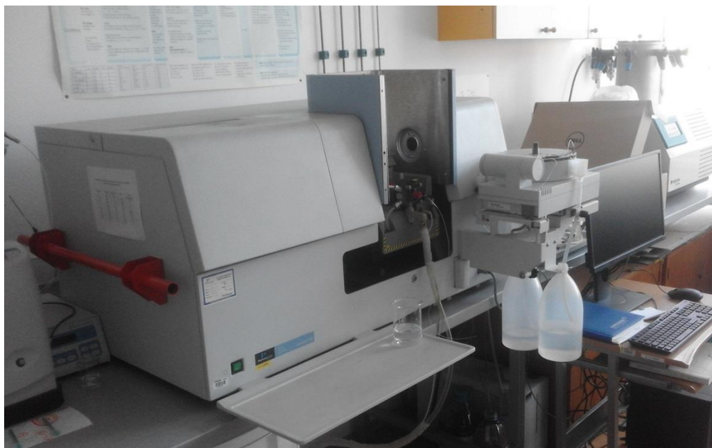
Slika 3.9. Atomski apsorpcijski spektrometar, PerkinElmer Analyst 700 (foto: Lazić, 2018).
