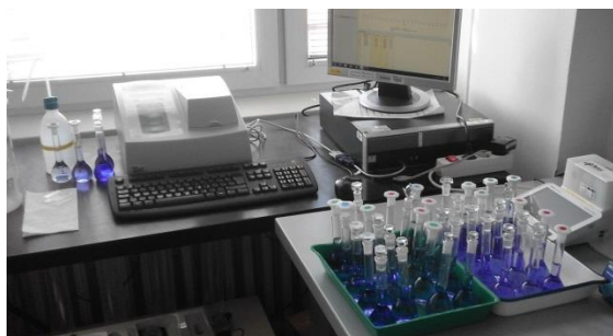
Slika 3.4. Spektrofotometar Genesys 20 (foto: Lazić, 2018).
