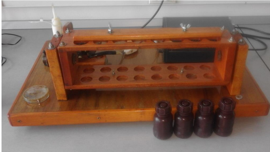
Slika 3.7. Tamne polibočice i “over-head” tresilica (foto: Lazić, 2018).
