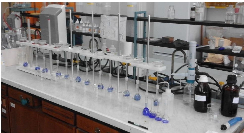
Slika 3.3. Priprema uzorak za analizu kapaciteta kationske zamjene Cu-trien metodom (foto: Lazić, 2018).
