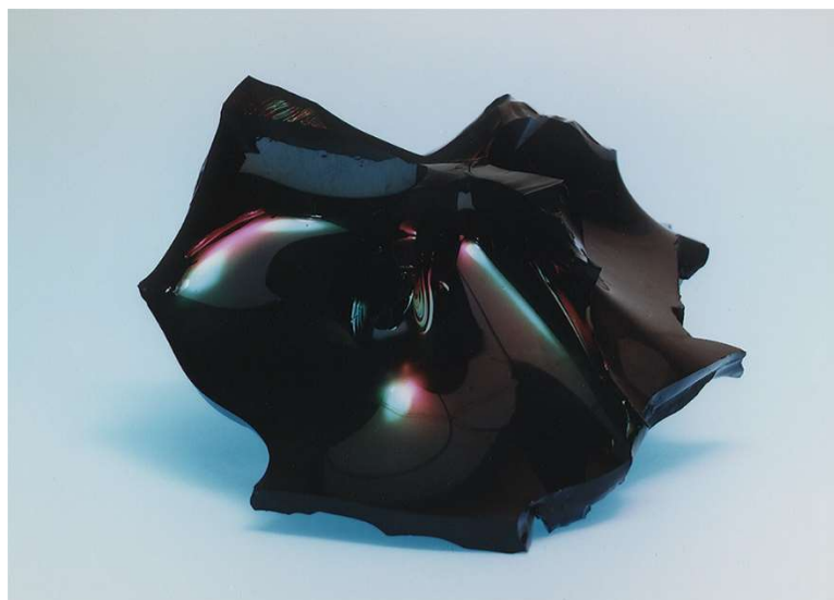
Slika 2-15 Borosilikatno staklo za vitrifikaciju VRAO-a (BENJI JEREW, 2019).
