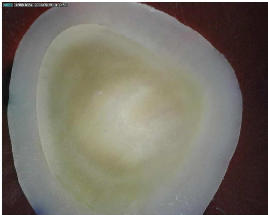
Slika 38. Slika uzorka s adhezijskom frakturom pod digitalnim mikroskopom Dino-Lite .
