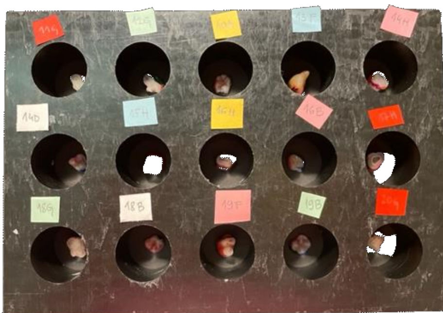
Slika 7. Dentinski presjeci prije ulaganja u akrilatnu smolu u kalupu Ultradent
