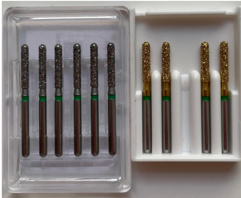
Slika 4. Dijamantna svrdla sa zaobljenim vrhom.
