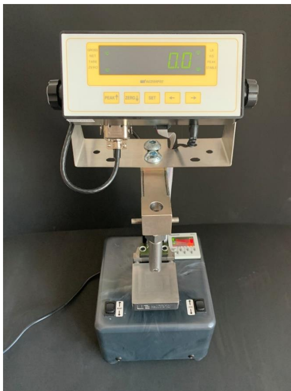
Slika 19. UltraTester stroj za ispitivanje vezne čvrstoće.
