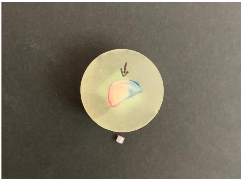
Slika 24. Odlomljeni kompozitni cilindar.
