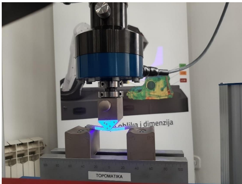
Slika 9. Ispitivanje uzorka od polilaktične kiseline (PLA) savijanjem u tri točke.
