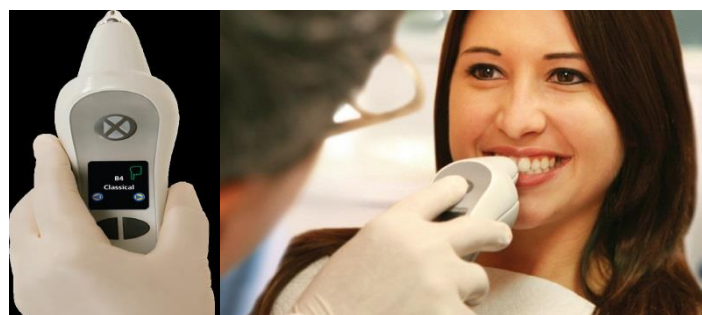
Slika 45. Shade X (X-Rite) spektrofotometar za točkasto mjerenje – promjer vrha 3 mm. Za obuhvaćanje cijelog zuba potrebno je provesti nekoliko mjerenja (preuzeto iz 144)
