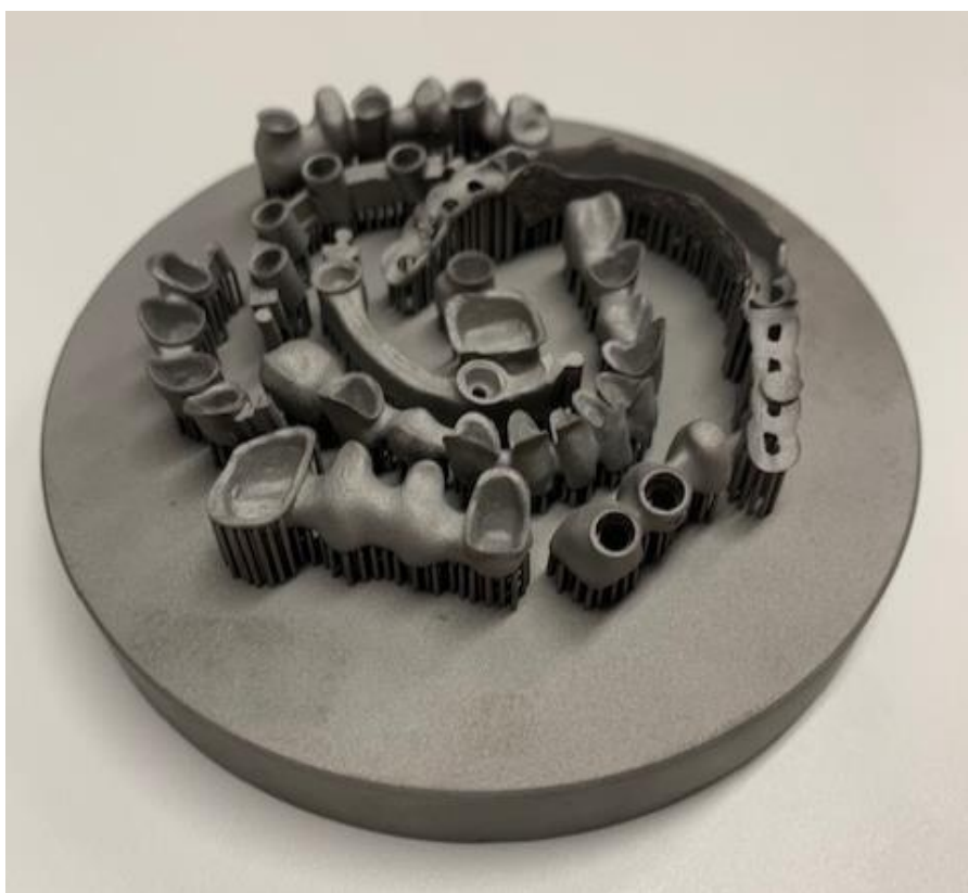
Slika 2. Metalne osnove protetskih radova izrađene 3D ispisom. Preuzeto s dopuštenjem autora: izv. prof. dr. sc. Nikša Dulčić
