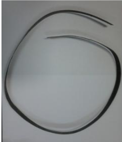
Slika 21. Fotografija Cu-Al-Mn hladno valjane trake debljine 1,02 mm
