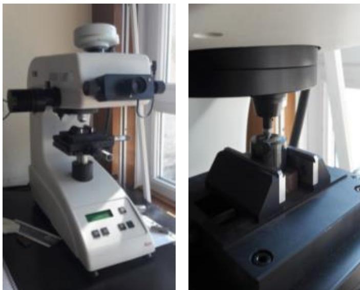
Slika 32. Fotografije tvrdomjera Leica VHMT
