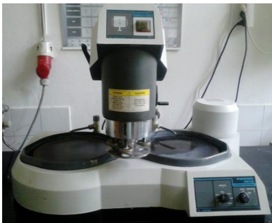
Slika 25. Fotografija uređaja za brušenje Buehler „Phoenix beta“
