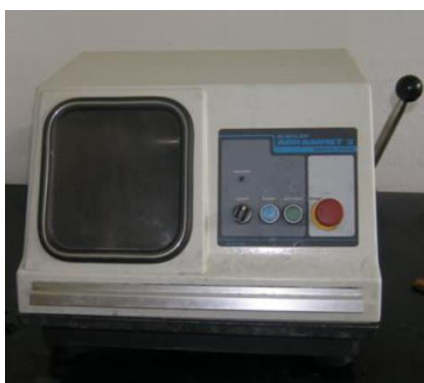
Slika 20. Rezalica Buehler ABRASIMET 2
