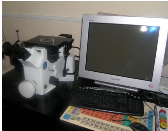
Slika 22. Invertni metalografski mikroskop Olympus GX 71
