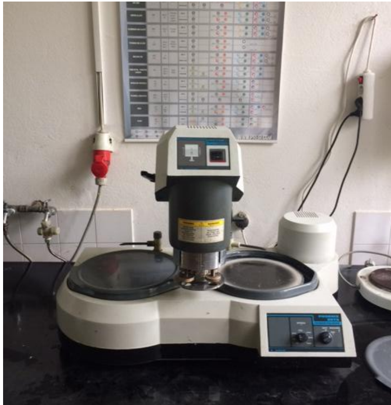
Slika 16. Fotografija uređaja za brušenje i poliranje, Buheler Phoenix Beta
