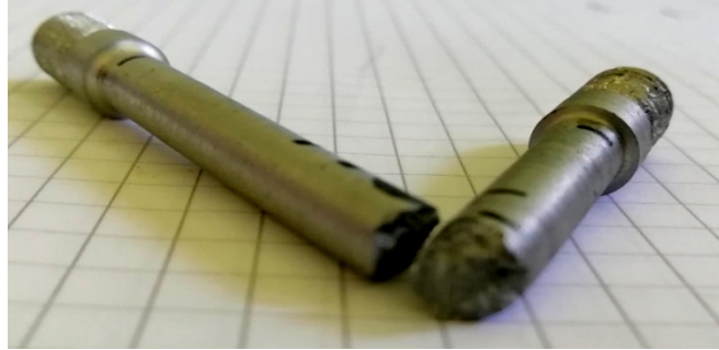
Slika 49. Uzorak za mehanička ispitivanja nakon kidanja
