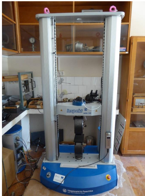
Slika 32. Kidalica HP inspekt table 100kN
