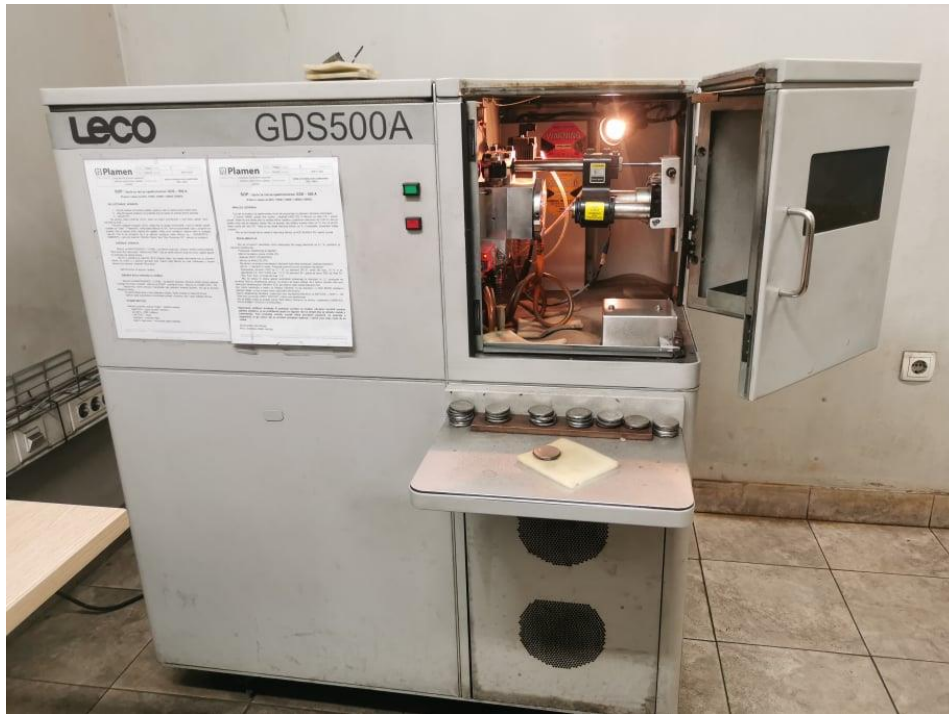
Slika 28. Optički spektrometar Leco GDS500A
