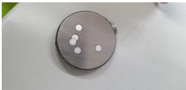
Slika 27. Uzorak za određivanje kemijskog sastava
