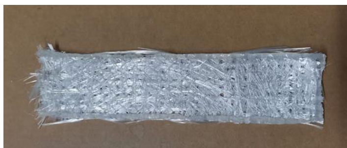
Slika 14. Silikon postavljen na rubove trake staklene mrežice.
