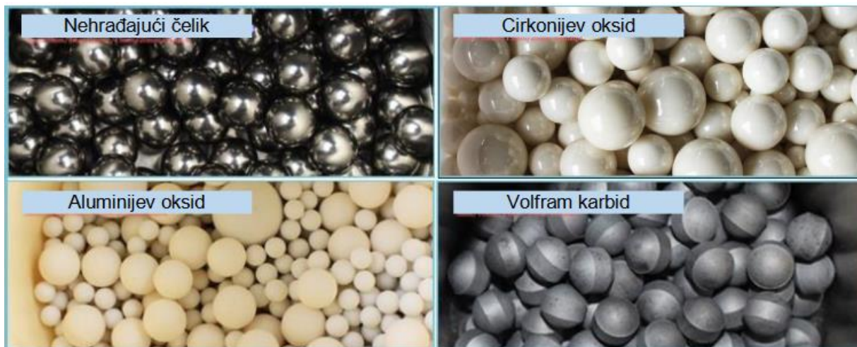
Slika 9. Kuglice za mljevenje od različitih materijala [11]
