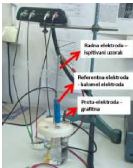
Slika 1. Troelektrodna ćelija za ispitivanje elektrokemijskom impedancijskom spektroskopijom
