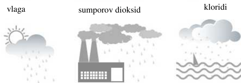
Slika 45. Čimbenici koji doprinose nastanku korozije [90]
