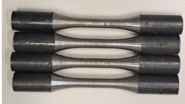
Slika 47 Epruvete na kojima se provelo testiranje
