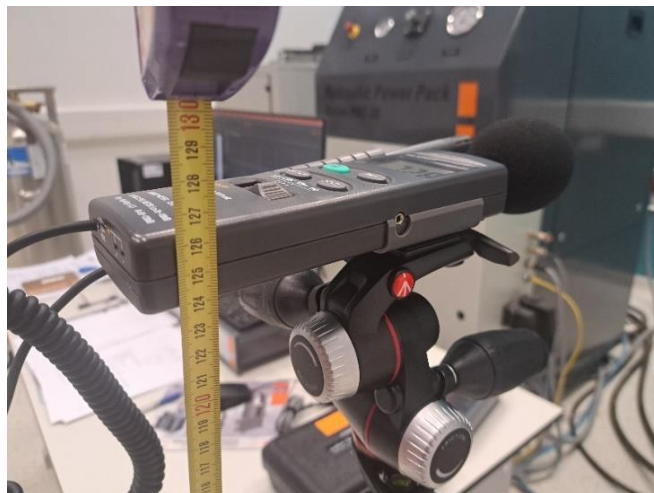
Slika 49 Postavljanje mikrofona na prihvatljivu visinu
