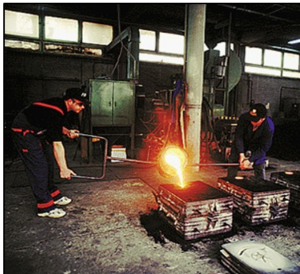
Slika 8. Ulijevanje taline u jednokratni kalup
