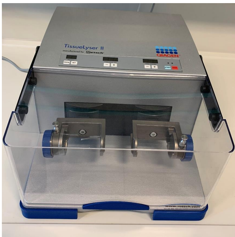
Slika 11. Uređaj Tissue Lyser za homogenizaciju micelija u epruvetama
