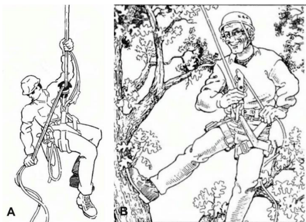
Slika 17. A) Silazak pomoću osmice (Preuzeto iz Jepson 2000). B) Silazak pomoću PETZL® STOP descendera (Preuzeto iz Jepson 2000).
