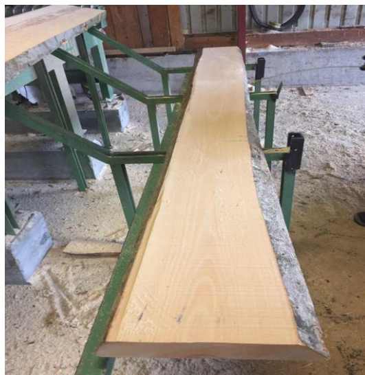
Slika 19. Detalj poprečnog presjeka i piljenica obične bukve
