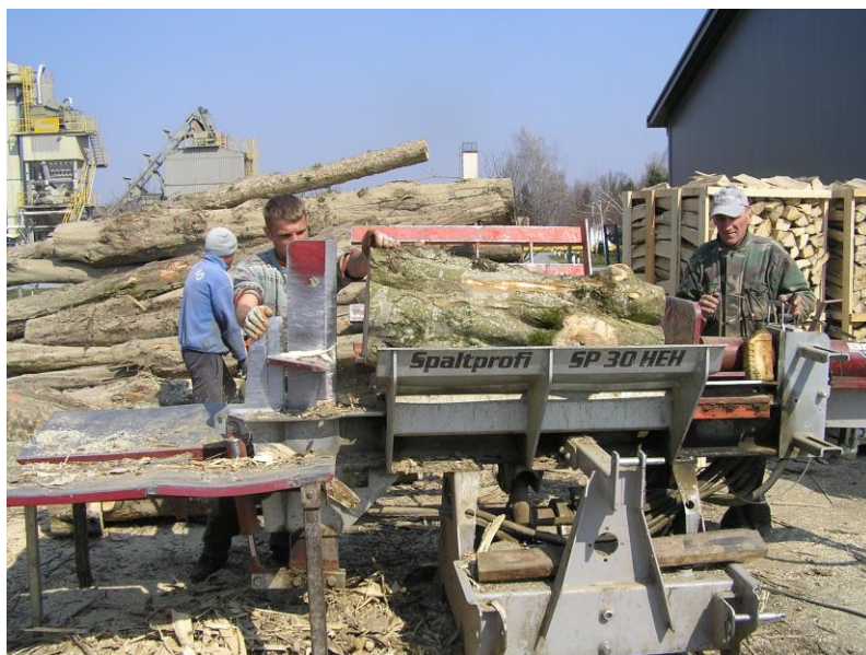
Slika 11. Cjepanje oblice na horizontalnom cjepaču
