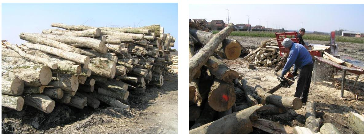
**Slika 10.** Stovarište višemetrice i prikrajčivanje na metražu
