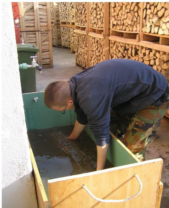
**Slika 25.** Mjerenje volumena cjepanica volumetrijskom metodom
