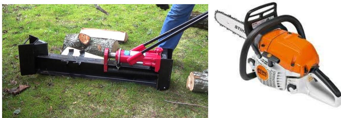
**Slika 8.** Ručni hidraulični cjepač i motorna pila
