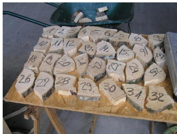
**Slika 26.** Uzorci iz cjepanica za potrebe mjerjenja vlage gravimetrijskom metodom
