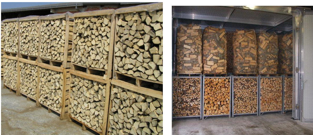
Slika 15. Prirodno i umjetno sušenje ogrjevnog drva
