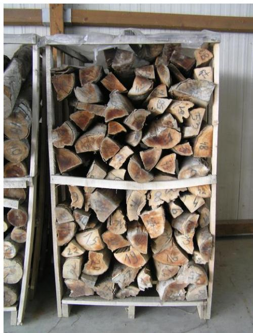
**Slika 23.** Složaj palete cjevanog ogrjevnog drva za mjerjenje u vlažnom i prosušenom stanju
