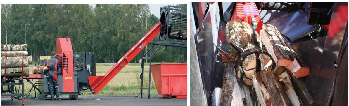
**Slika 14.** Automatski stroj za piljenje i cjepanje višemetrice
