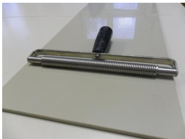
Slika 10. Nanošenje premaza spiralnim aplikatorom na polipropilensku ploču
