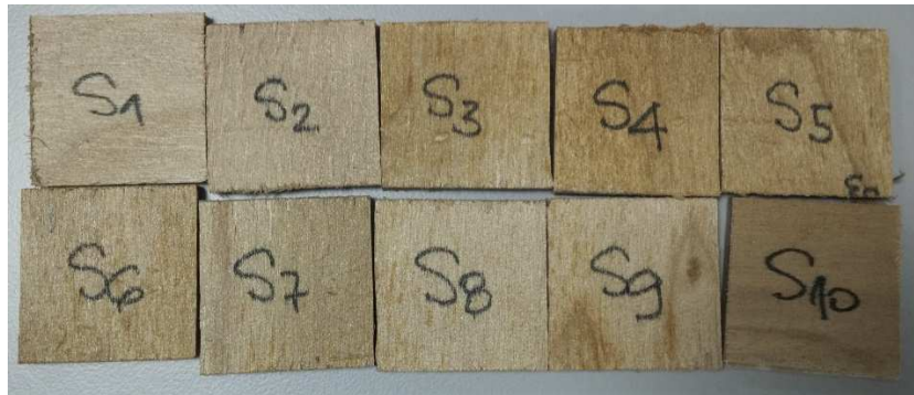
Slika 9. Uzorci WPC pripremljeni za ispitivanje fizikalnih svojstava
